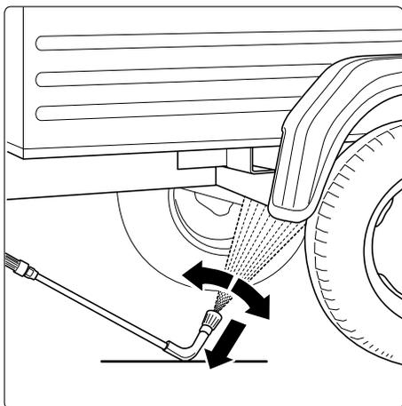
При использовании кофья для чистки днища снизу кофье обязательно следует опустить на землю!
