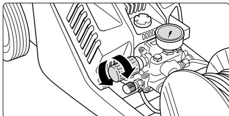
**12.** Бесступенчато регулировать рабочее давление при помощи маховичка. Максимально имеющееся давление твердо установлено на заводе.
