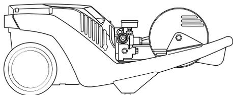
**1.** Очиститель высокого давления Kränzle 2160 TST, 2195 TST, 2175 TST со шланговым барабаном и шлангом высокого давления длиной 15 м из металлической ткани, номинальный диаметр 6
