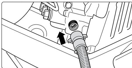
**1.** Снять всасывающий шланг с фильтром (принадлежности Kränzle № 15.038 3). При использовании других шлангов внутреннее поперечное сечение шланга должно быть не меньше  $3/4" = 16 \text{ мм}$ .
