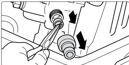
**2. Перед каждым пуском в работу проверять чистоту сетки на входе воды.** Вручную открутить элемент подключения шланга. При помощи острогубцев вынуть серийную сетку на входе воды и при наличии загрязнений очистить.
