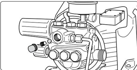
Снять обратный клапан и проверить на наличие загрязнений или повреждения уплотнительного кольца.
