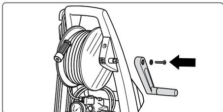
**4. Поставить аппарат вертикально.** Вывернуть крепежный винт из шестигранника шлангового барабана, насадить складную рукоятку на шестигранник и закрепить винтом.
