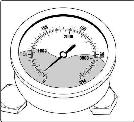
Манометр показывает слишком малое давление, несмотря на открытый регулятор давления, из сопла выходит непостоянная струя. Вибрация шланга высокого давления.
