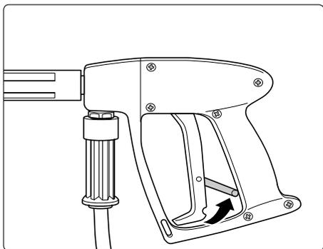
Предохранительный затвор на пистолете перекидывать после каждого пользования, чтобы предотвратить непроизвольное распыление!
