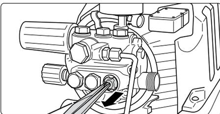
При помощи острогубцев выньте корпус клапана (с зеленой или красной оболочкой) вместе с кольцом круглого сечения. Проверьте уплотнительное кольцо на наличие повреждений. В случае повреждения кольцо круглого сечения следует заменить.
