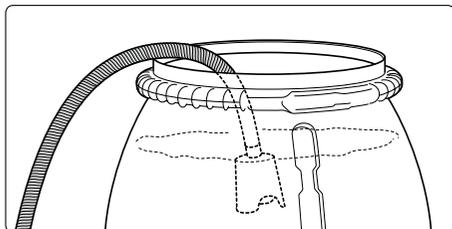
**3.** Заполненный водой всасывающий шланг ввести в емкость и начать процесс чистки.
