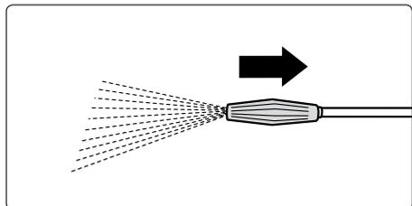
**3.** Подача химического вещества автоматически прекращается при перекрывании сопла „Vario“ путем его перемещения назад. Дать впитаться средству для чистки, а затем произвести распыление под высоким давлением.
